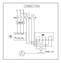
Rectifien type: 6 pole half wave excitation rectifier
